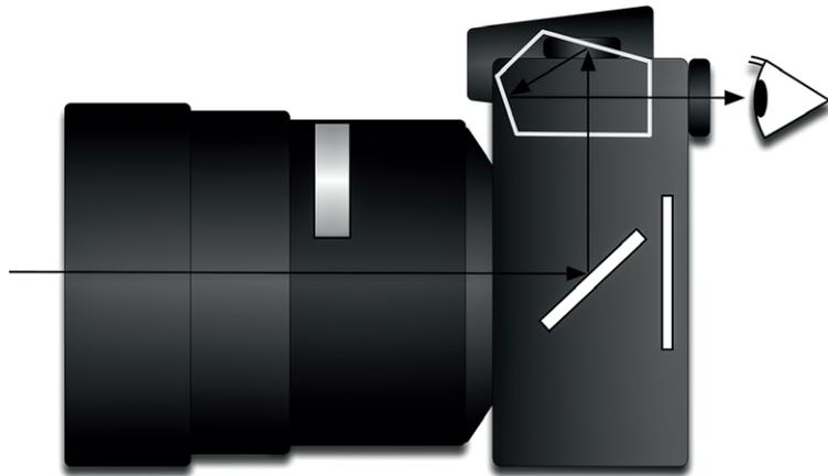
Das Bild wird mit einer DSLR komponiert, indem man durch den Sucher blickt. Wenn der Auslöser gedrückt wird, klappt der Spiegel hoch und gibt den Weg für das Licht frei. Vor dem Sensor sitzen zwei sogenannte Vorhänge. Diese steuern die Belichtungszeit. Das Öffnen des ersten Vorhangs startet die Belichtung, am Ende der Belichtung läuft der zweite Vorhang hinterher und verdeckt den Sensor wieder. Zuletzt klappt der Spiegel wieder herunter und die Vorhänge gehen zurück in ihre Ausgangsposition.
